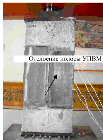
Рис. 3. Отслаивание листа УПВМ от поверхности бетона образца PF3 (справа)
