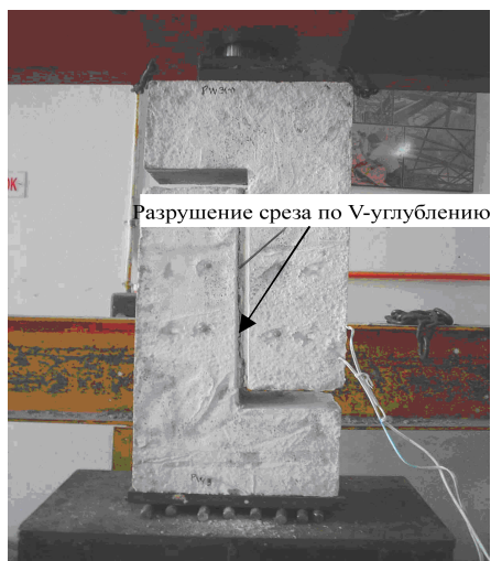
Рис. 2. Разрушение по плоскости среза образца P1 (слева)
